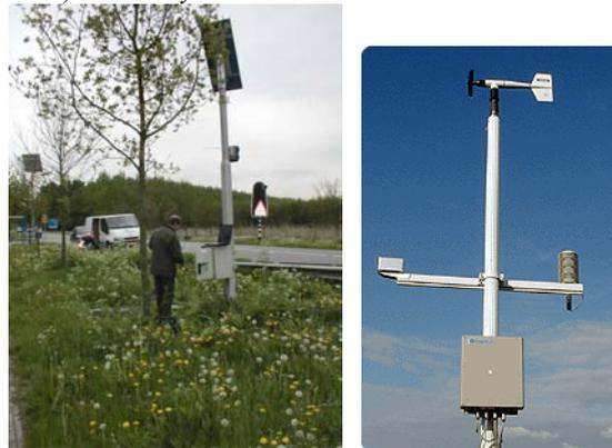
Figure 2 et 3 : Mats radar et caméra associée avec des capteurs météo
