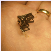
Micromechanical Flying Insect (Berkeley)
